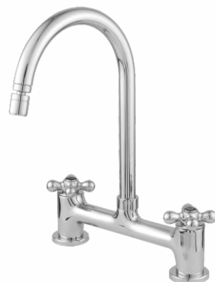
4180 Misturador Cozinha Génova Bancada Giratória Cano 13/16" com Arejador Articulado 1/4 de Volta M22 Acabamentos: C31, C34, C52, C72
